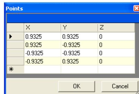
Une autre manière d'y parvenir est de dessiner d'abord un rectangle avec le point en bas à gauche sur l'origine, puis de modifier la hauteur et la largeur du rectangle dans les propriétés (mettre les 2 valeurs à 1,856).
