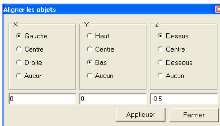
Il peut être plus commode de référencer le Z = 0 de la machine au niveau de la table, puis d'utiliser une valeur de **Surface pièce** qui est égale à la hauteur Z du brut. Cela fonctionne bien lorsque le matériau utilisé a une surface inégale ou il est difficile de prendre une référence avec l'outil (surtout après une passe d'ébauche). Cela peut aussi simplifier l'usinage double face. Si vous utilisez cette méthode, utilisez les options d'alignement suivantes pour l'axe Z:
